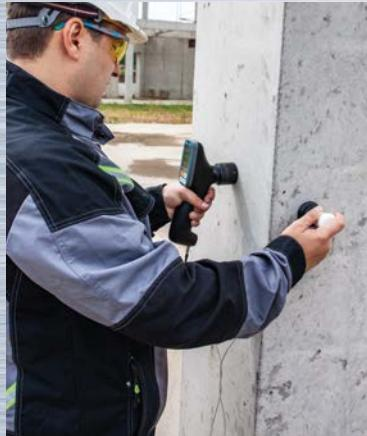
В корпус ультразвукового тестера A1410 Pulsar жестко установлен приемный преобразователь, состоящий из семи капсул - преобразователей с сухим точечным контактом (СТК). Аналогичная передающая антenna решетка (АР) подключается с помощью одинарного кабеля LEMO-LEMO.
